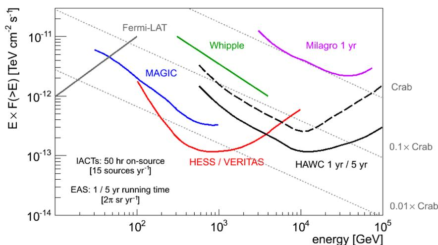
Figura 1: Curvas de sensibilidad en función de la energía y del tiempo de integración para el instrumento LAT del satélite *Fermi*, los telescopios Cherenkov (Imaging Atmospheric Cherenkov Technique, IACTs) MAGIC, HESS, VERITAS y Whipple, y los detectores HAWC y Milagro (fuera de servicio desde 2008), que detectan la radiación Cherenkov en agua inducida por las partículas de las cascadas iniciadas en la atmósfera por rayos cósmicos o fotones gamma.
